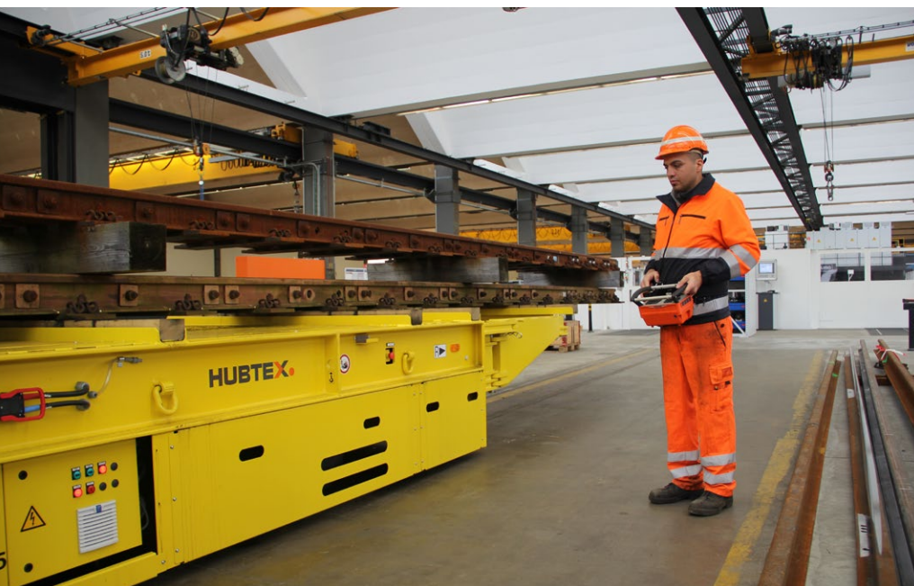
Abb. 3 Die Joysticks ermöglichen das Vorwärts- und Rückwärtsfahren sowie das Lenken nach rechts und links. Über einen Schalter können die verschiedenen Fahrprogramme wie Längs-, Quer- oder Kreisfahrt bestimmt werden.
