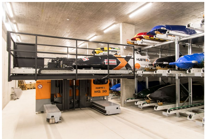
Abb. 2 Mit dem Mehrwegestapler mit Beladeplattform werden die Bobs über eine Greifvorrichtung auf die Plattform gezogen.
