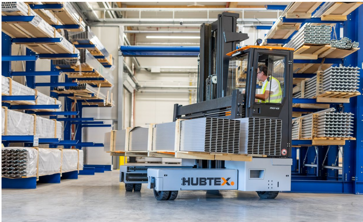
Abb. 7 Elektro-Mehrwegestapler bringt Wendigkeit ins Lager.
