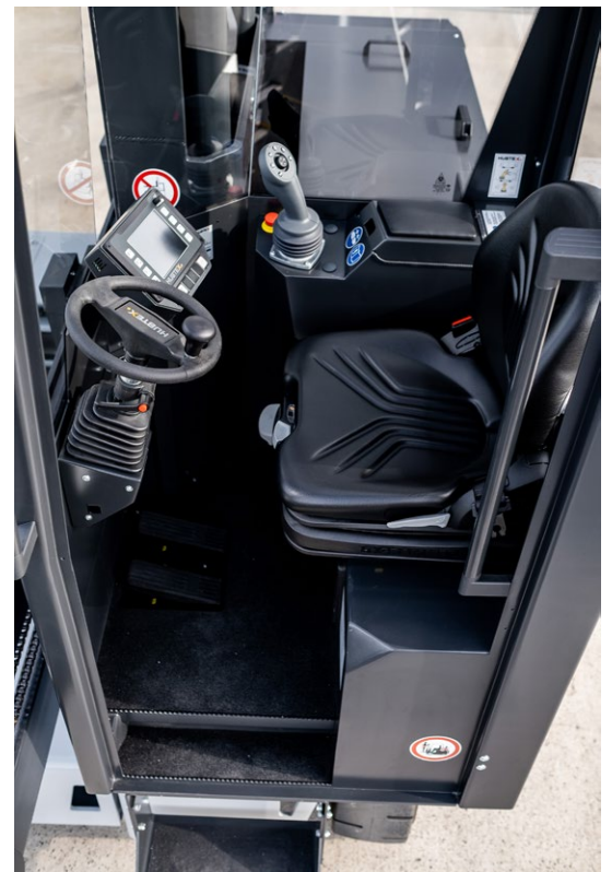
Abb. 6 Ergonomische Fahrerkabine mit bester Rundumsicht, Joystick und Multifunktionsdisplay HIT 3.
