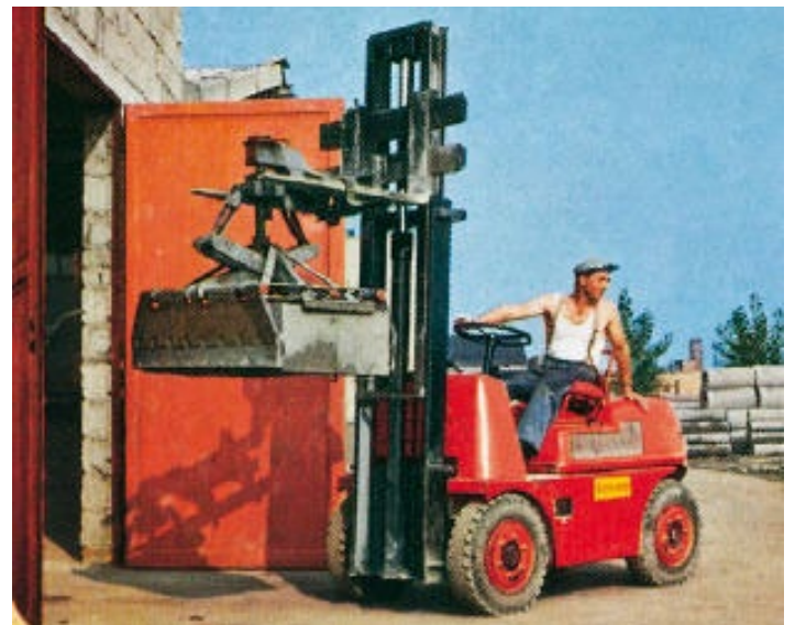
Abb. 5 Der Linde Hubtrac war 1959 der erste Stapler mit hydrostatischer Kraftübertragung. Diese ermöglicht ein stufenloses Beschleunigen ohne Getriebe – vorwärts wie rückwärts, mit voller Motorleistung!
