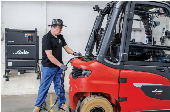
Abb. 14 Bei konventionellen Batterien gilt die Empfehlung, immer nur volle Ladezyklen anzustoßen, um die Batterien zu schonen. Ganz anders bei Lithium-Ionen-Batterien: Hier ist selbst äußerst kurzes Zwischenladen von nur wenigen Minuten nicht nur erlaubt, sondern sogar erwünscht. Durch die Flexibilität beim Laden erhöht sich die Gesamtverfügbarkeit von Fahrzeugen signifikant.
