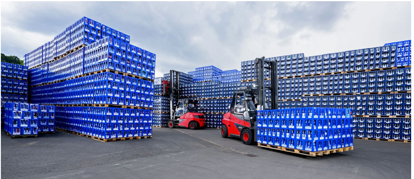
Abb. 11 Hohe Tonnagen, weite Fahrwege im Blocklager, häufiges Heben und Senke sind für den Linde E80 mit 6-Fach-Klammer und Lithium-Ionen-Batterie kein Problem – selbst im Mehrschichtbetrieb nicht.
