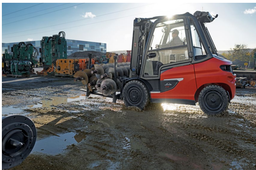
Abb. 12 Fahrwerk und Chassis der Linde X-Elektrostapler sind auf höchste Belastungen ausgelegt, sodass die Stapler auch auf unebenen Untergründen eingesetzt werden können.
