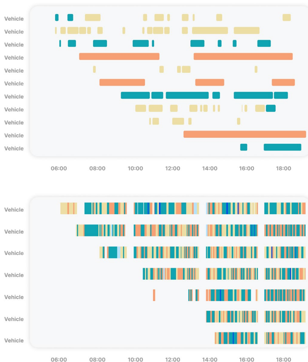
Abb. 2 Auftragsverteilung ohne (oben) und mit SYNAOS IMP (unten) im Vergleich
