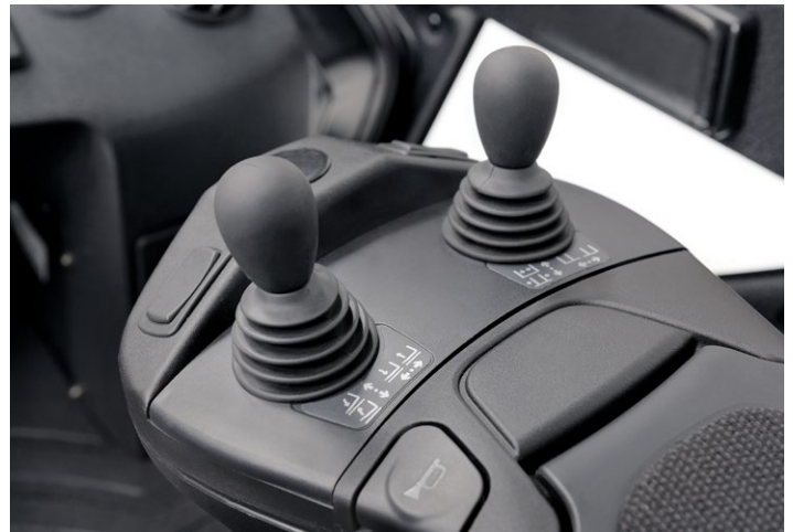
Abb. 7 Mithilfe der Linde Load Control lassen sich Arbeits- und bis zu vier Zusatzhydrauliken des Staplers ebenso einfach wie präzise steuern.
