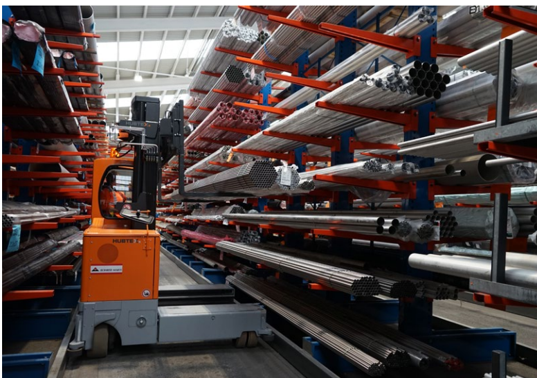
Abb. 5 Die Mehrwegestapler von HUBTEX kommen bei Hans Kohler beim Handling von groß dimensionierten Blechen und langen Profilen zum Einsatz.
