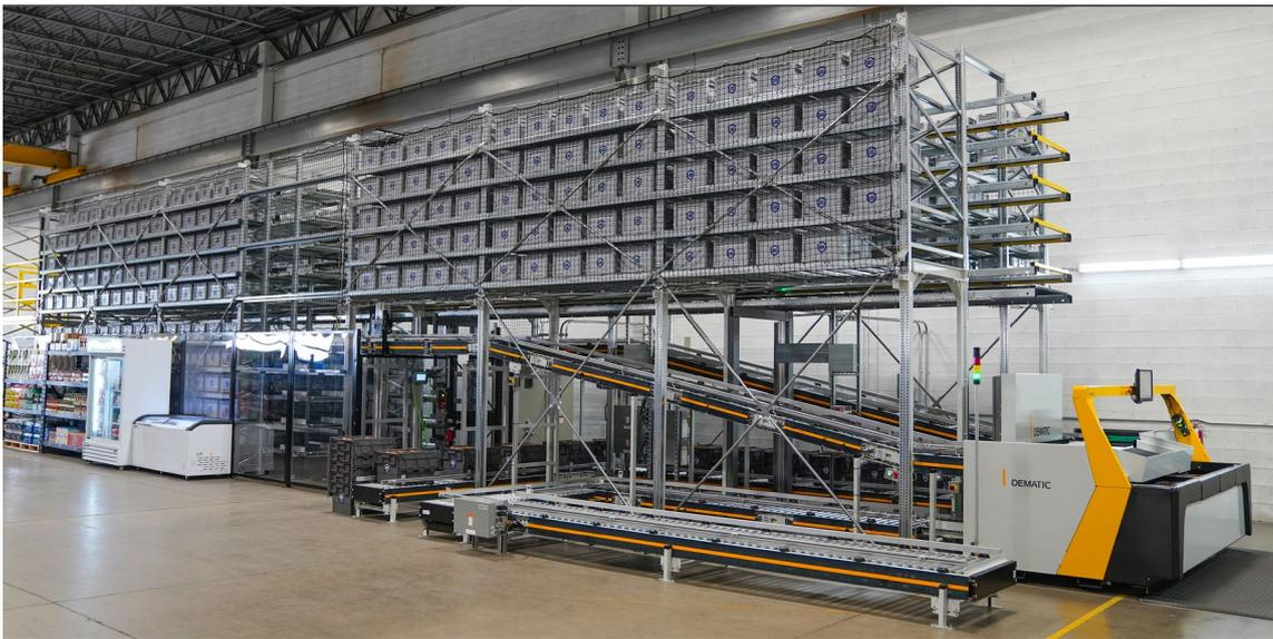
Micro-Fulfillment, Auftragsabwicklungssystem mit hoher Lagerdichte und hohem Durchsatz. Es ist darauf ausgelegt Aufträge innerhalb einer Stunde abzuwickeln. Bild: Dematic
