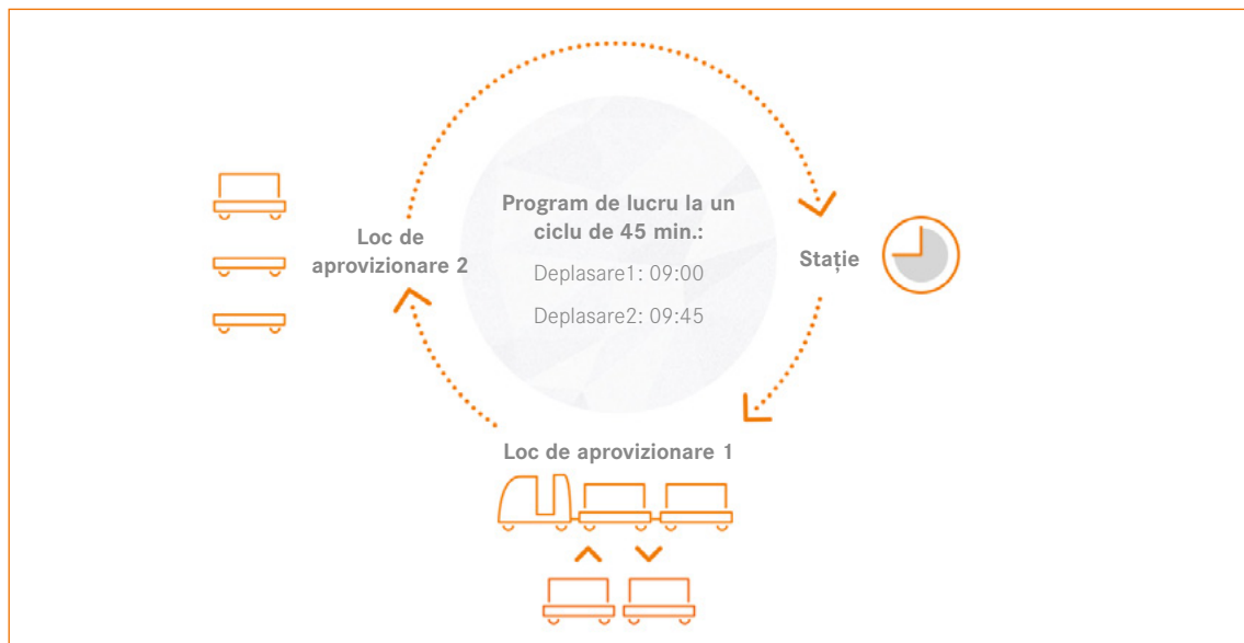
Exemplu de program de lucru al unui convoi industrial între stație și locurile de aprovizionare.
