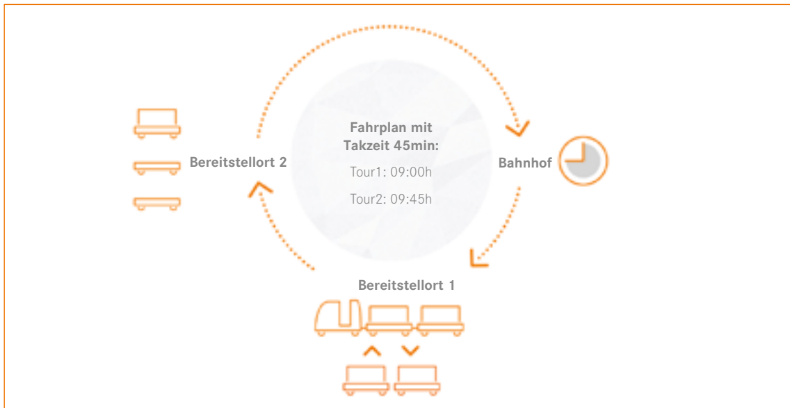
Beispielfahrplan eines Routenzugs zwischen Bahnhof und Bereitstellorten.
