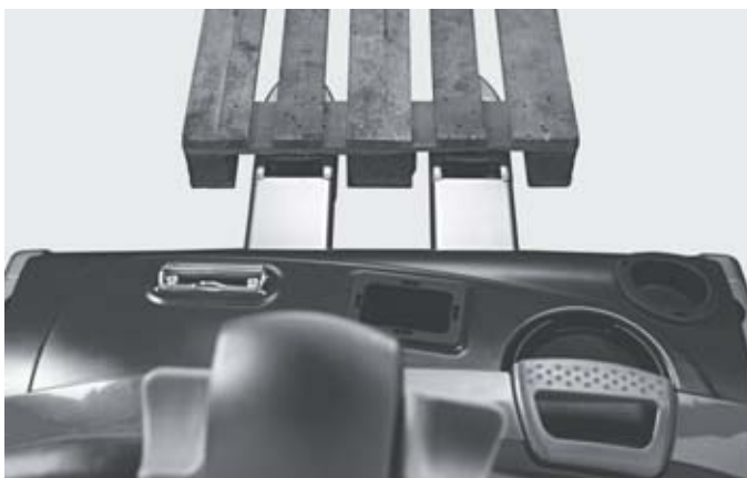
Contrôle visuel des pointes de fourches
